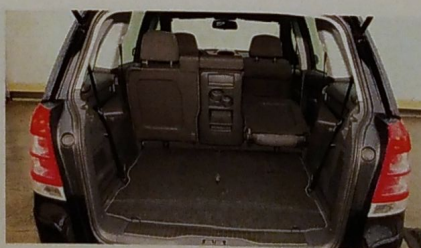
▲ Tyłne fotele idealnie chowają się w podłodze bagażnika (Opel nazywa to Flex7).
